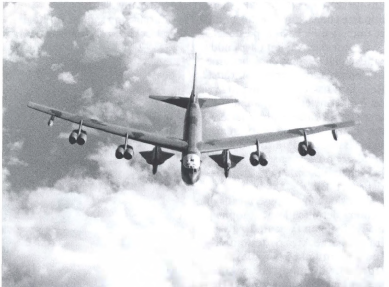
Det ubemandede D-21 fly robotfly (her ses to under vingerne) blev brugt til spionagetogter og bl.a. sendt ind over Kina. D-21B blev sendt af sted fra et B-52H bombefly og kunne nå op på en hastighed nær Mach 4 i 80.000-95.000 fods højde. (Foto: USAF)
