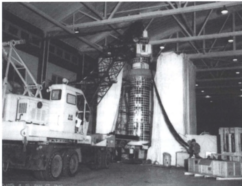
Et fire tons tungt kamera klargøres inden opsendelsen med en Skyhook-ballon. (Foto: USAF)
