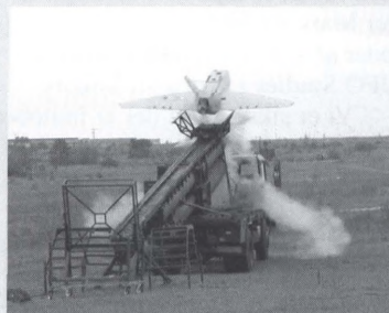
Tårnfalken sendes af sted med en katapult. Dronen er en mellemstor UAV på ca. 300 kg, men de fås i alle størrelser.
