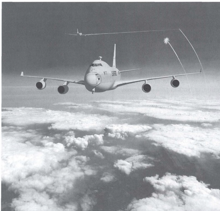
The Airborne Laser (ABL) våbensystem skal operere over skydækket, hvor det kan spore fjendtlige missiler og derefter udpege missilet med laserstrålen, som er så kraftig, at missilet ødelægges, inden det kan gøre skade. Det kraftige laservåben er placeret i næsen på et modificeret Boeing 747-400F fragtfly. (Tegning: © 2003 The Boeing Company)
