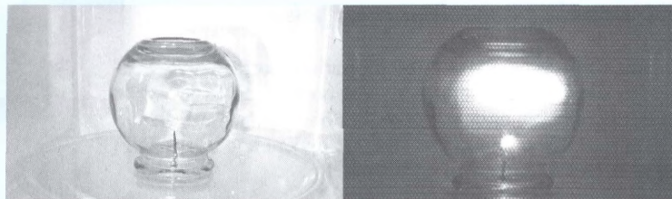
I denne glasbeholder anbragt i en mikrobølgeovn opstod et stabilt plasmoid ledsaget af en høj summen.
