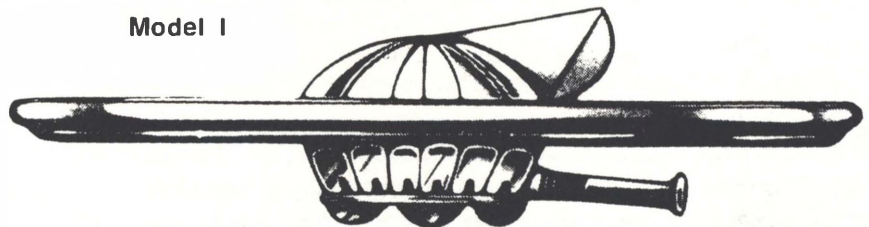
Den første prototype prøvefløjet i 1941-42. Denne model blev fremdrevet af bl.a. en kæmpepropel, hvilket gav kraftige vibrationer ved høje hastigheder. Denne prototype blev kaldt »Flugelrad« eller »vindhjul«, og var udstyret med et flylignende haleror og en jet-motor, kaldet »Walterrohr«.
