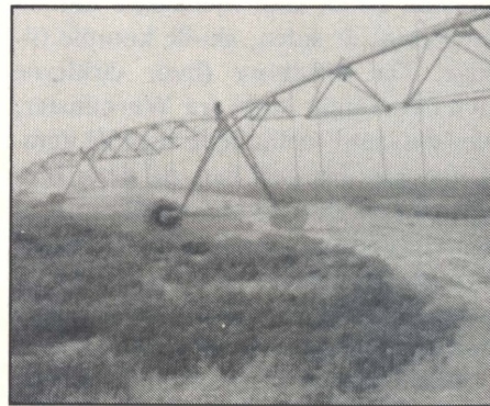
Detalje fra kunstigt vandingsanlæg i ørkenen i Saudiarabien. Den centrale rotor, en 84 meter lang vandingsarm roterer én gang i døgnet og forsyner en 50 hektar stor rund lucernemark med så meget vand, at der kan høstes 10 gange om året.
