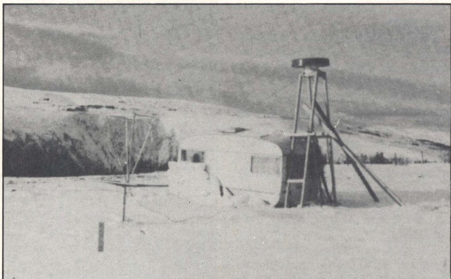
»Project Hessdalen«s hovedkvarter på Aspåskjølen. Ved siden af campingvognen ses en »Atlas 2000« radar med en rækkevidde på 33 km. Det øvrige udstyr bestod bl.a. af en seismograf, et fluxgate magnetometer, en spektrumanalysator, infra-red viewers, geigertællere, videokameraer og -optagere samt mange forskellige typer kameraer.
