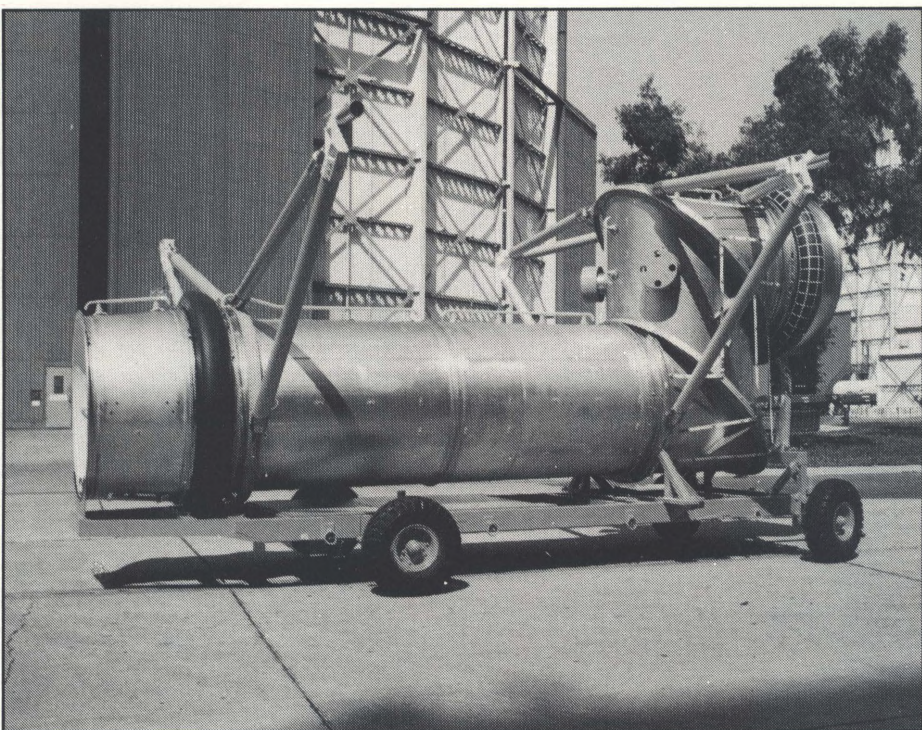
Specialtunnel til brug for passage mellem rumfærgen og spacelab rumlaboratoriet.
