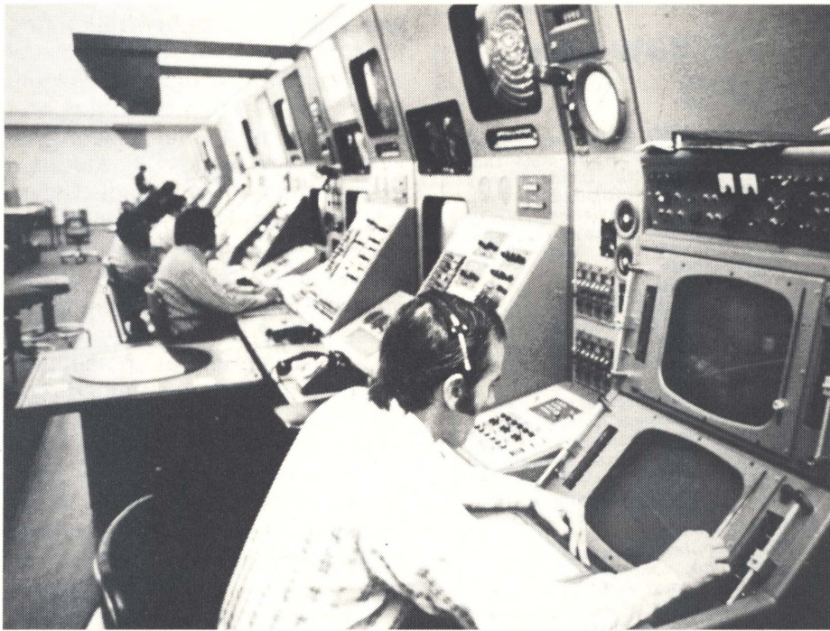
På dette ældre billede fra Toronto Center (Canada) ses forrest to GCA finale scoper (GCA = Ground Controlled Approach) af den type som også blev anvendt af Royal Air Force (RAF). På næste pult ses foroven et GCA search scope.
