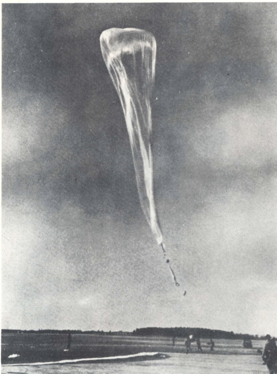
Skyhook-ballonen blev udviklet for den amr. flåde i 1947-48 på basis af professor Jean Piccards planer for en plast-ballon. Den er fremstillet af polyethylen og er i bunden forsynet med en bærerang af metal, hvortil de forskellige videnskabelige instrumenter kan fastgøres. Den første model kunne bære over 45 kg instrumenter, diameteren var 22 meter og højden 31 meter (begge mål fuldt oppustet). Her vises opsendelsen af en Skyhook fra Minnesota. Den medbringer udstyr til måling af kosmisk stråling. Ballonen er kun delvis oppustet; herved undgås, at ballonen sprænges ved det lavere atmosfæriske tryk i større højder. (Ballonen fyldes med ikke-brændbart helium).
