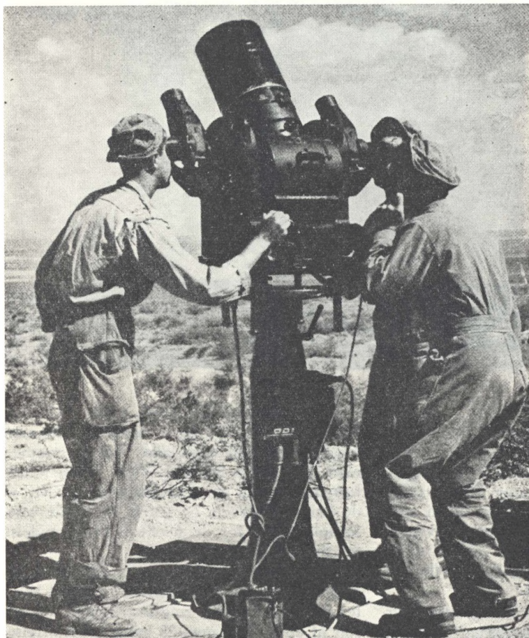
Fig. 2. Foto-theodolit stationen på White Sands forsøgsområdet.
