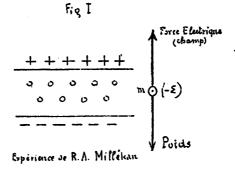
Le champ électrique est réglé de façon à compenser l'attraction gravitique (le poids) et à maintenir la particule m (d'huile) immobile (en équilibre) entre les deux plateaux ou armatures. La force électrique qui agit de bas en haut sur m (—  $\epsilon$ ), égale au produit du champ H par la charge ( $\epsilon$ ) de la particule, équilibre alors le poids de celle-ci :  $H\epsilon = p$ .
