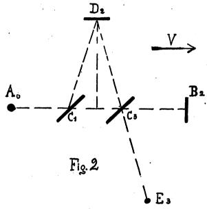
(Fig 2) Cette figure est tracée dans l'Ether fixe; l'appareil ctant entraîné à la vitesse V dans la direction A B (C1 vient en C2).
