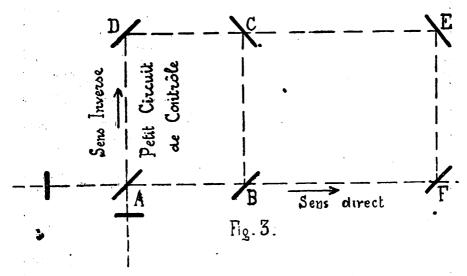
AFEDA et ABCDA. Deux circuits rectangulaires avec 6 miroirs: DEF sont réfléchissants; ABC semi-réfléchissants, demi-transparents. Les rayons lumineux se déplacent dans le vide. Le petit circuit ABCD sert à produire des franges destinées à être comparées à celles du grand circuit AFED où les rayons se propagent en sens contraire. Telle est l'expérience de Michelson et Gale.
