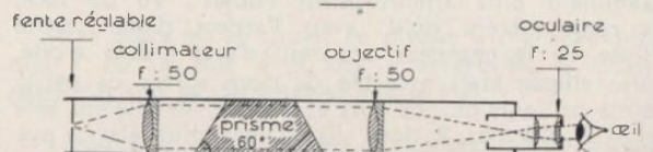
SPECTROSCOPE — schema de principe
